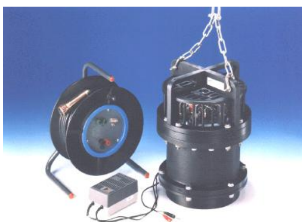
C8 Fig.10: Mosselmonitor® in versione da campo
