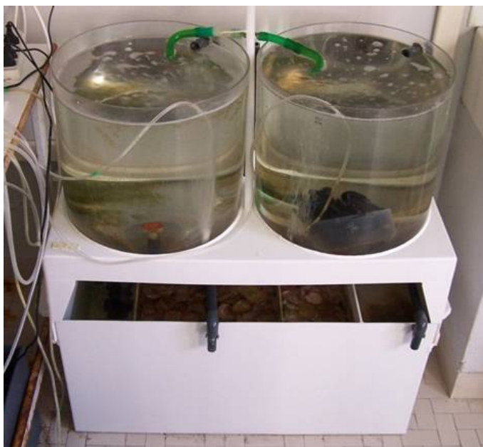
C8 Fig. 12 – Foto dell’impianto per l’installazione del Mosselmonitor ® in laboratorio
