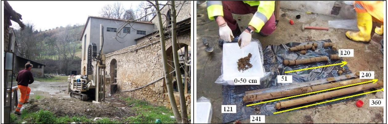
**Figura 16.** – Una sonda a percussione in azione, a terra.
