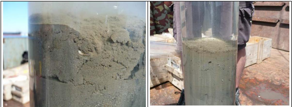
**Figura 40.** – I sedimenti veri (anche se talvolta ancora un po’ contaminati) della Rada di Augusta, con evidenti tracce di *bioturbation*<sup>21</sup> in prossimità del contatto con l’acqua, chiara come la si vede nella foto anche al momento delle manovre di presa del campione.
