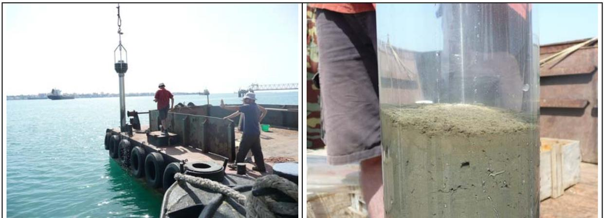
**Figura 19.** - Carotiere a gravità in azione.
