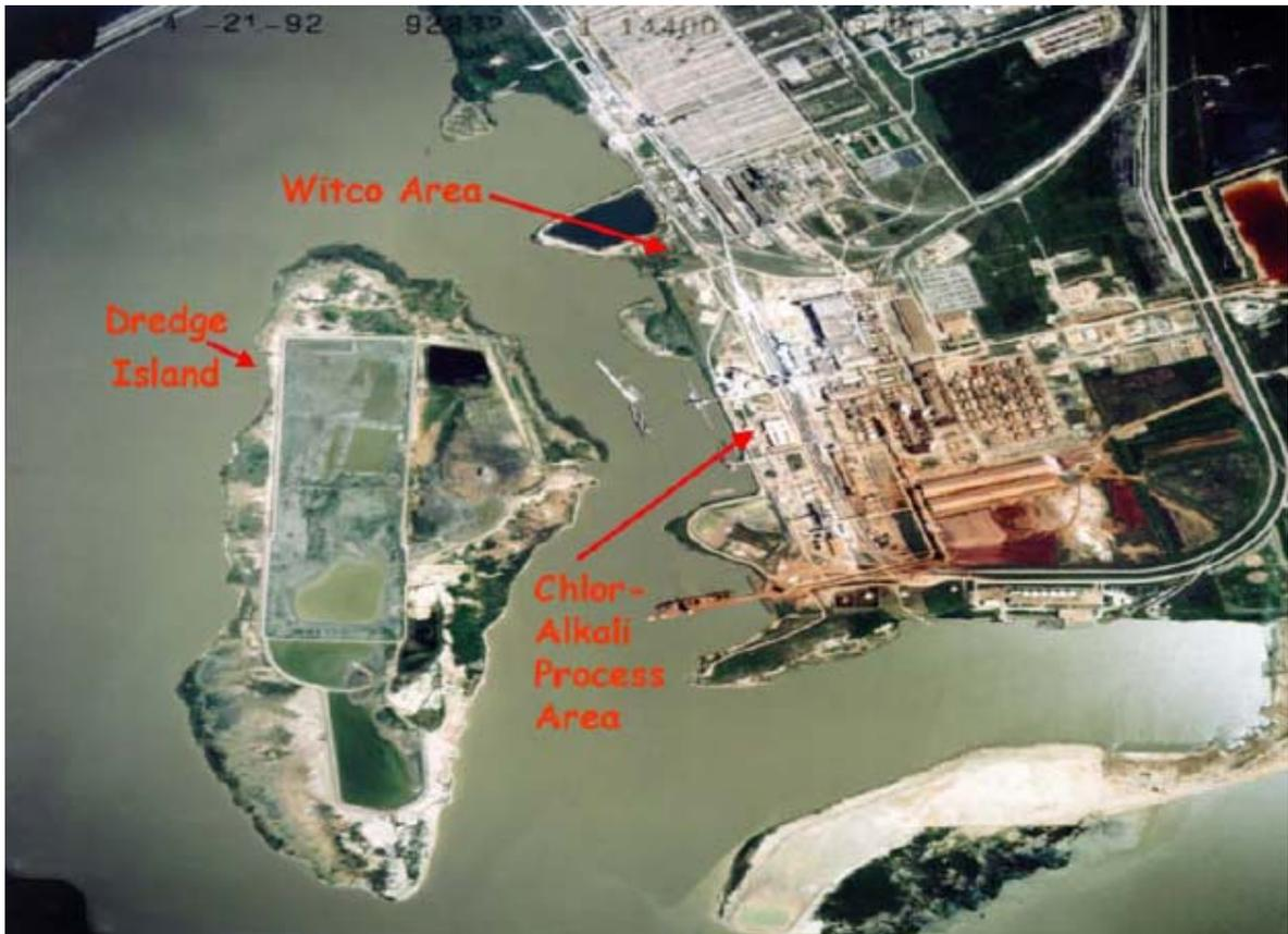
**Figura 36** – Dettaglio della *Dredge Island*. Si tratta di una isola che c'era anche prima del polo industriale, sulla quale sono stati accumulati fanghi industriali (**non di dragaggio**). Qui i sedimenti sono quasi esclusivamente sedimenti, seppur contaminati in varia misura.
