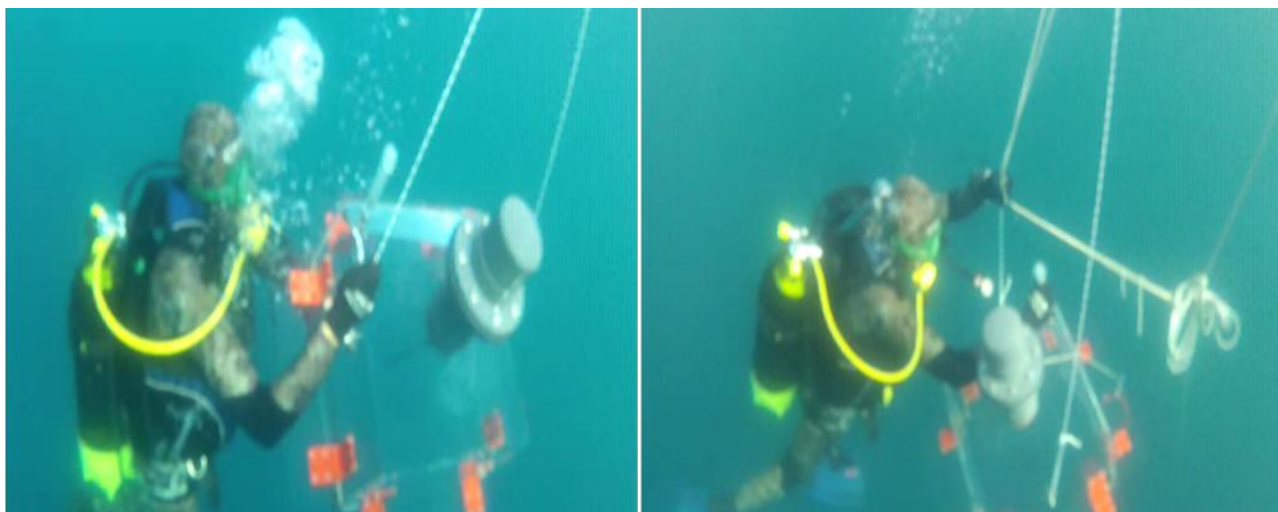
Fig. 7: Posizionamento della camera bentica sul fondo marino per il campionamento dell'acqua all'interfaccia acqua-sedimento (foto subacquee)
