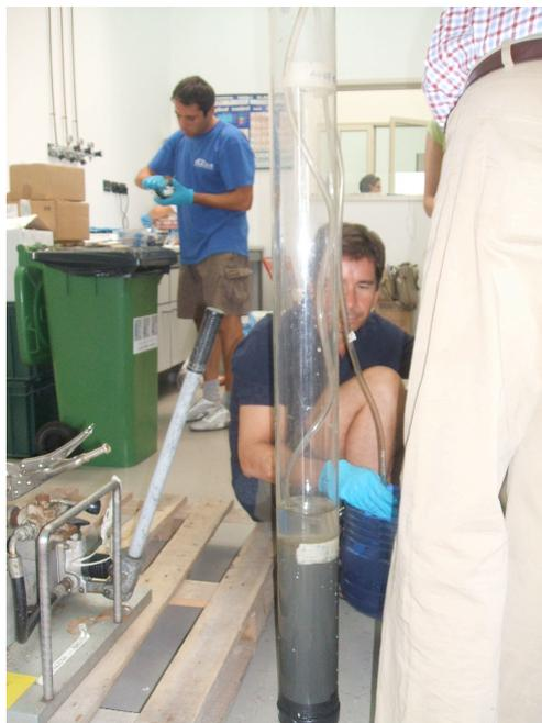
**Fig.11- Dettaglio del sistema di aspirazione dell'acqua presente al top delle carote prelevate con sistema SW104.**
