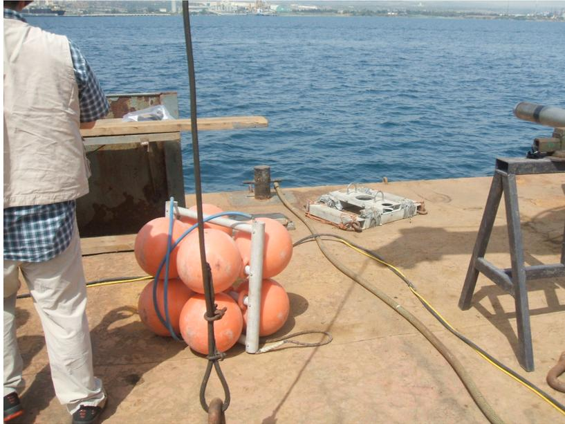
**Fig.2b- Zavorra per la stabilizzazione dell'asta del carotiere e galleggianti per il mantenimento verticale delle aste.**
