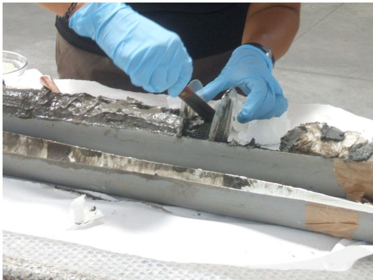
**Fig. 14- Dettaglio relativo al campionamento di carota prelevata tramite sistema di carotaggio a vibrazione.**
