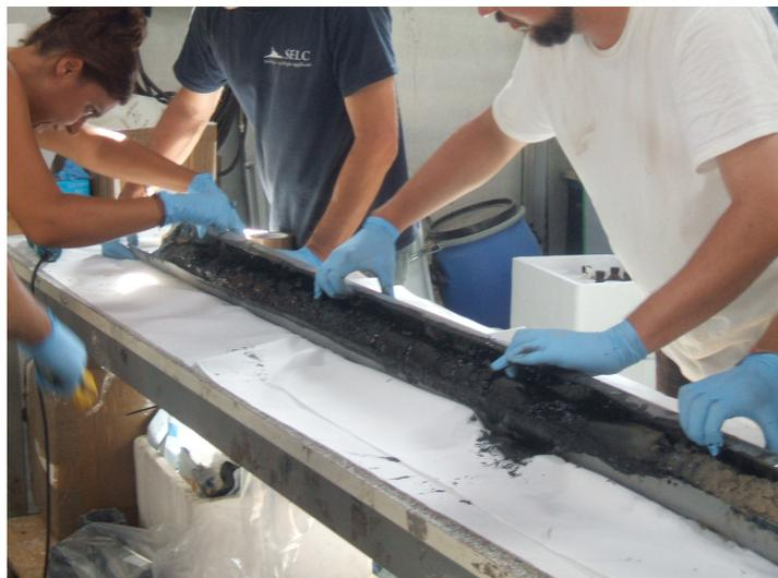
**Fig.9- Taglio mediante sega elettrica del liner prelevato con carotiere a vibrazione.**
