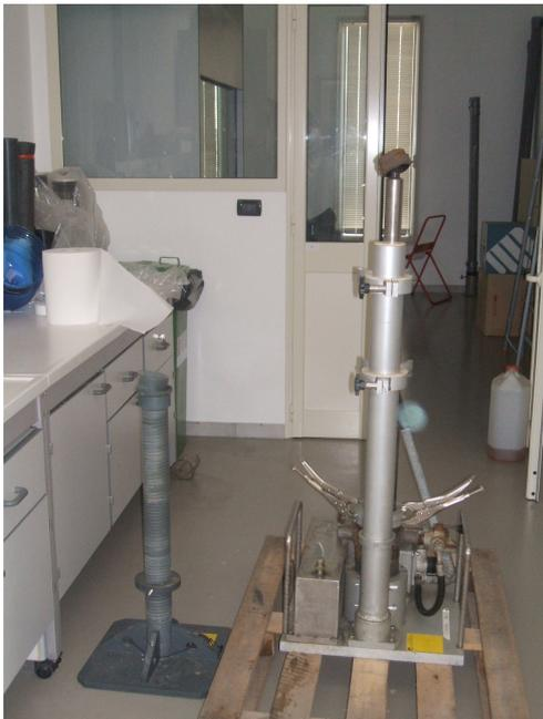
**Fig. 7a-Dettaglio dell'estrusore manuale
