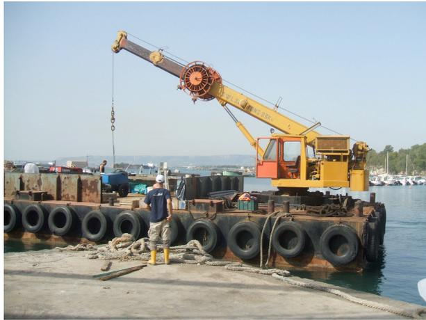
**Fig.1 – Motopontone con la gru utilizzata per le manovre del carotiere a vibrazione e del carotiere SW104.**
