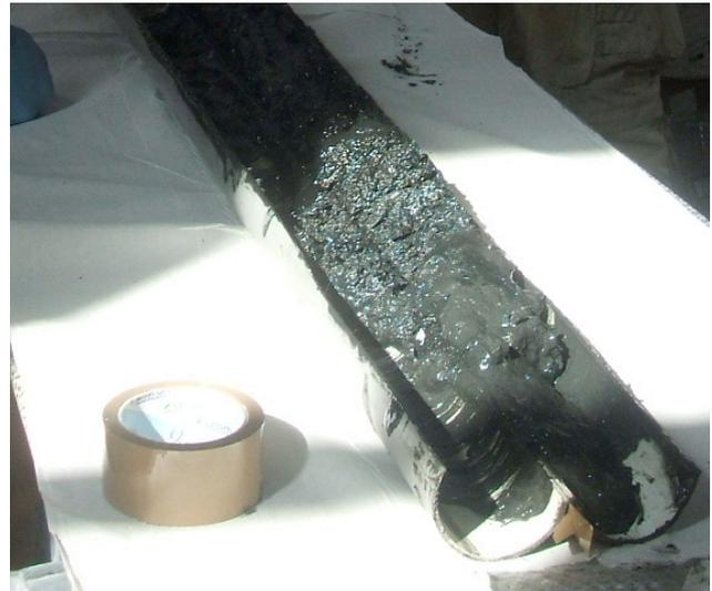
**Fig10-Dettagli relativi alle parti superiori delle carote prelevate con vibrocarotiere**
