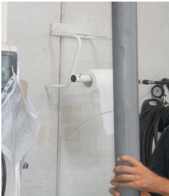
**Fig.10. Dettaglio del foro creato per permettere la fuoriuscita dell'acqua presente nella parte superiore del liners a seguito del campionamento effettuato a mezzo carotiere a vibrazione.**
