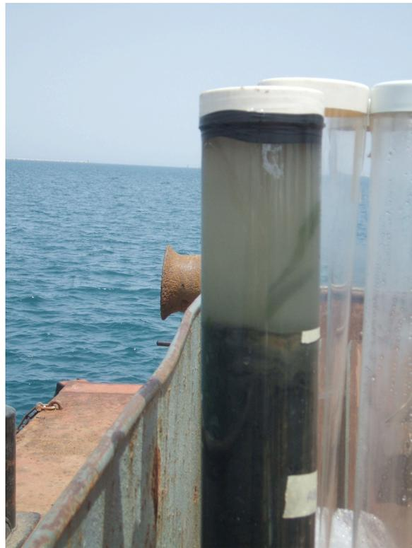
**Fig.6- Dettaglio dell'interfaccia acqua-sedimento della carota prelevata con il sistema SW104**
