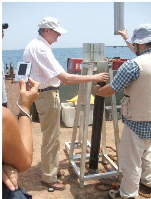
**Fig.4- Carotiere SW104 dopo la perforazione**
