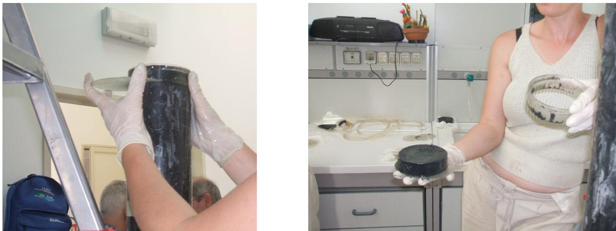
**Fig.12-Dettaglio relativo alle operazioni di prelievo di sedimento dalle carote prelevate con sistema SW104.**
