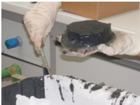
**Fig.13- Dettaglio relativo all'asportazione della parte esterna del sedimento.**
