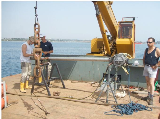
**Fig.2a- Carotiere a vibrazione con asta da tre metri. Alla destra c'è il motore per il sistema di vibrazione**
