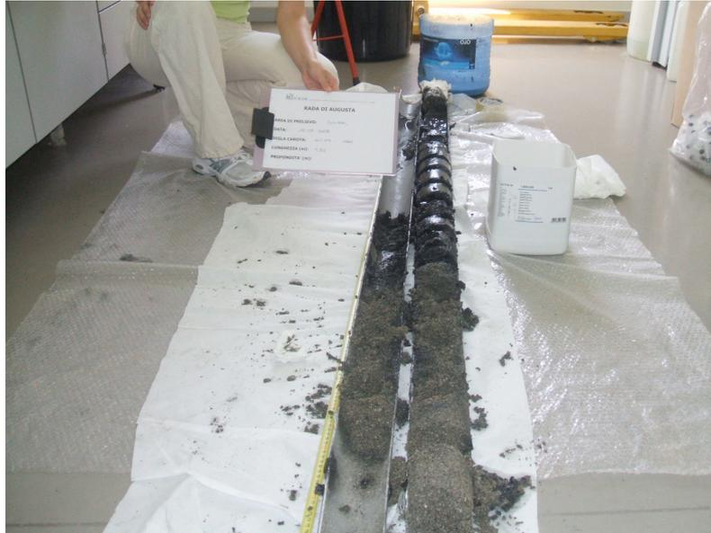
**Fig. 16- Esempio di carota prelevata con sistema a vibrazione a seguito della fase di campionatura.**
