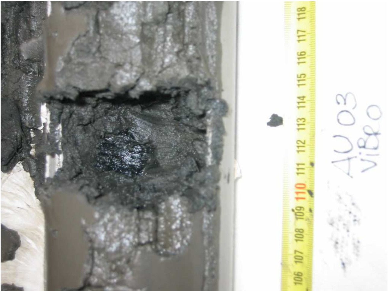
Figura 54: Particolare del livello contaminato a 100-120 cm nella carota AU03 VBR.
